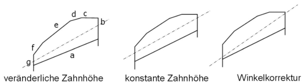
Abbildung 4.32: Theoretische Zahnberandung, Abbildung entnommen aus [SHS06]
