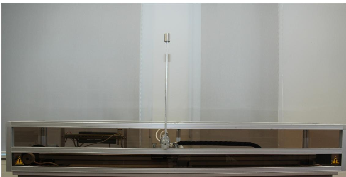
**Abbildung 6.5:** Versuchsstand für das Wagen-Pendel-System.
