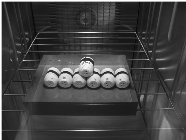
Abbildung 3.14: Kalibrieranordnung im Klimaschrank.
