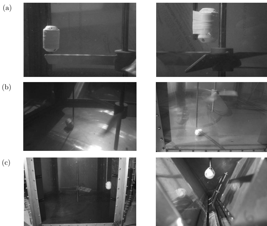
Abbildung 5.2: Messpositionen des Sensorpartikels zur Erfassung des Staudruckes im Rührkessel: (a) in der Nähe der Rührblätter, (b) auf dem Behälterboden und (c) an einem Stromstörer in Wandnähe.
