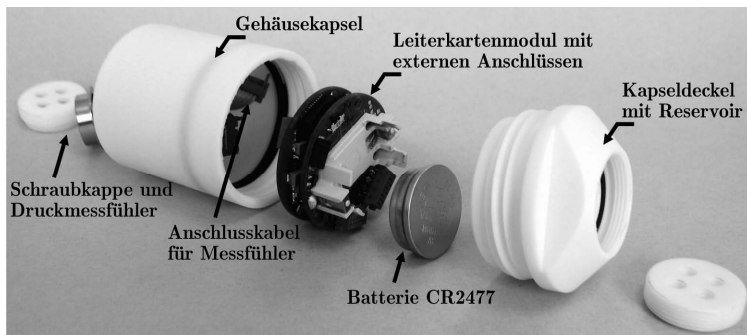
Abbildung 4.11: Fotografie des Sensorpartikels im geöffneten, demontierten Zustand. Leiterkartenmodul der Erfassungselektronik mit den Anschlusskabeln für den Druck- und Temperaturmessfühler, der Batterie (CR2477) sowie der geöffneten Gehäusekapsel.
