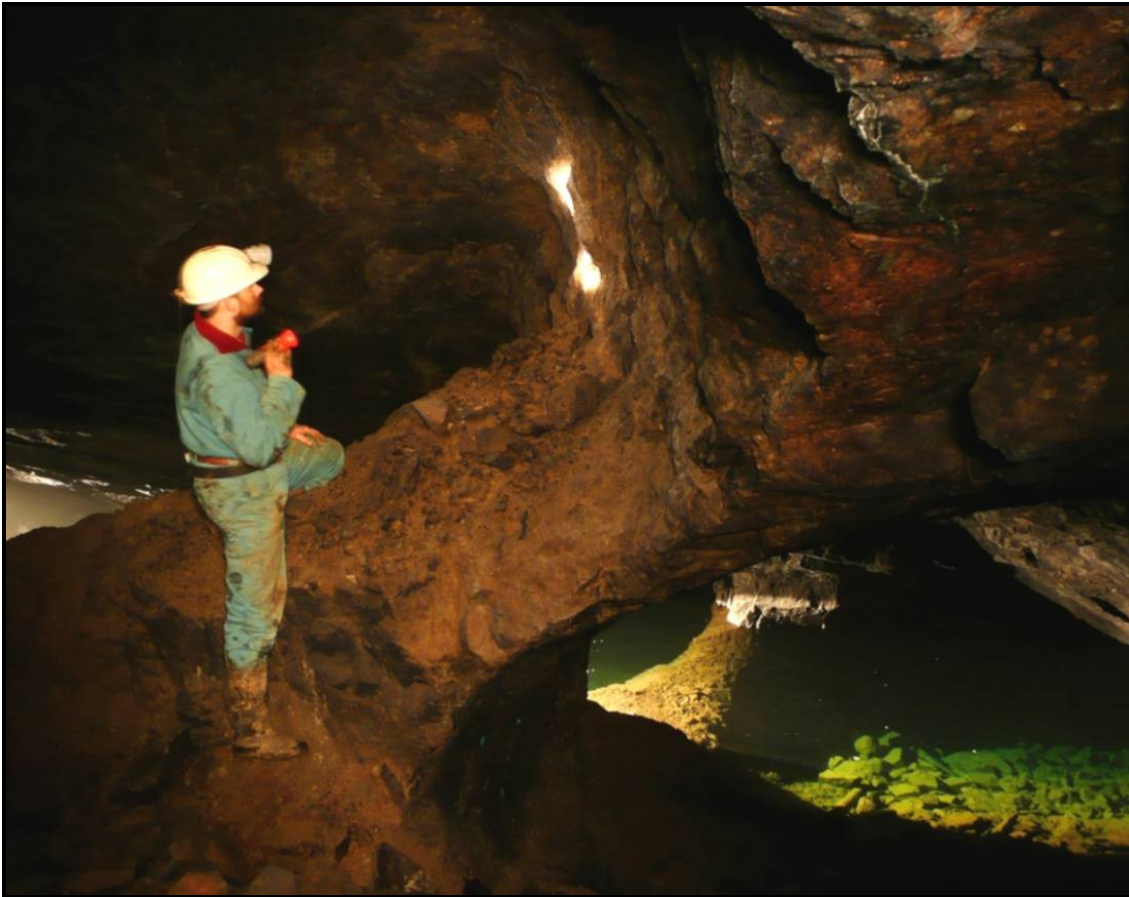
Abb. 52: Stützpfeiler und Weitungsbaue im Mutter Gottes Lager.
