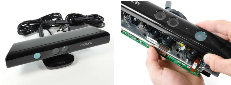
Abb. 17.1: Kinect-Sensorleiste (Soules & Wiens 2011): NIR-Projektor, RGB-Kamera, NIR-Kamera (v. l. n. r.).
