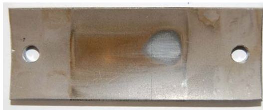
Abbildung 6.9: G2-Laufbahn nach dem Fresslastversuch. Beginnender abrasiver Verschleiß am UT. (Anm.: Tropfenschmierung über OT.)
