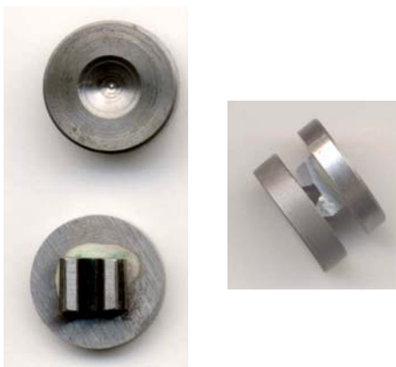
Bild 5.3 / Prüfkörper zur Reibbeiwertmessung mit einem SRV-Gerät
