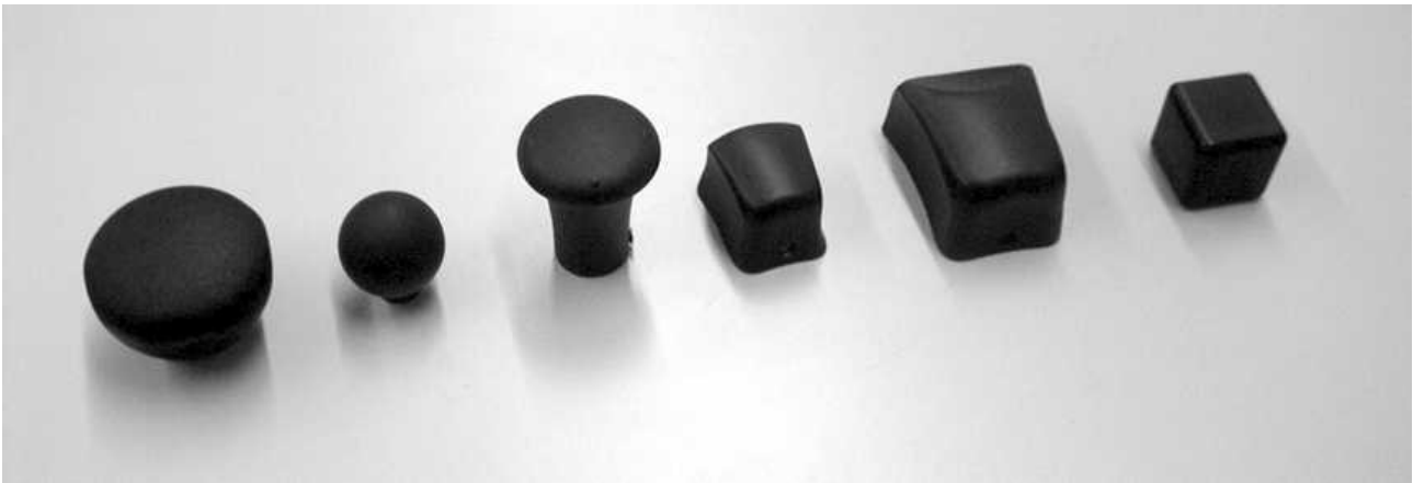
Abbildung 3.13: Formen zur Codierung der Bedienhandlung Ziehen (Tille u. Krüger, 2004): v.l.n.r.: Pilz, Kugel, Ziehpilz, kleines "Moncherie", großes "Moncherie", Würfel
