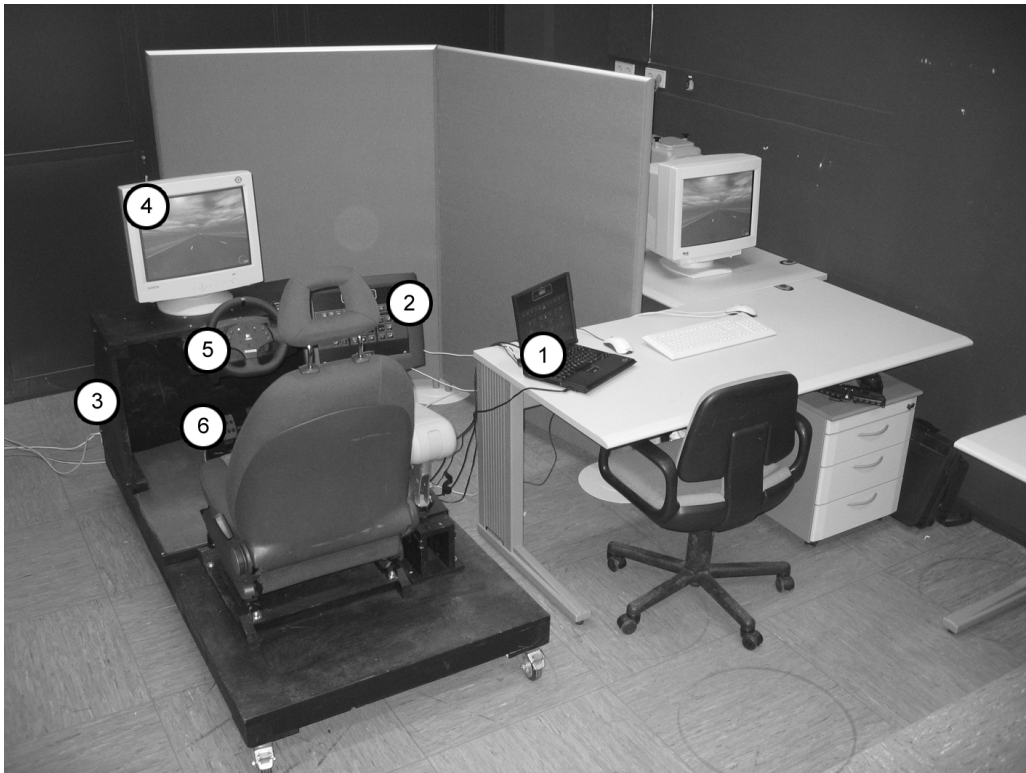
Abbildung 4.2: Versuchsaufbau zur Untersuchung variabler Beschriftung von Tasten. Simulations-Laptop (1), Touchscreen (2), Fahrsimulations-PC (3), Darstellung der Fahrsimulation Lane-Change-Test (4), Lenkrad (5) und Pedalerie (6)
