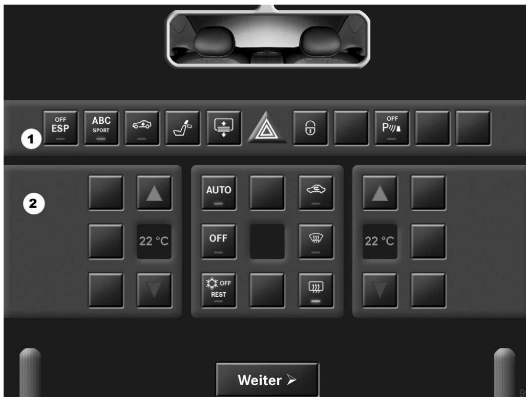
Abbildung 4.3: Simulation variabel beschrifteter Tasten auf dem Touchscreen: Oberes Bedienfeld (1) und Klimaanlage (2). Dargestellt sind ausgeblendete, zustandscodierte Tasten.
