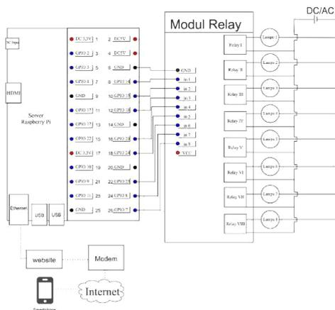
Gambar 4 Rangkaian Keseluruhan
