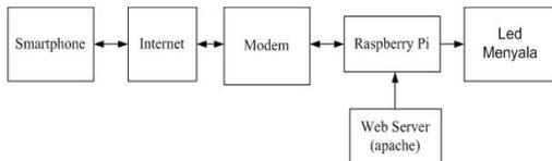
Gambar 3 Diagram Blok Alat Kontrol Listrik Berbasis Web
