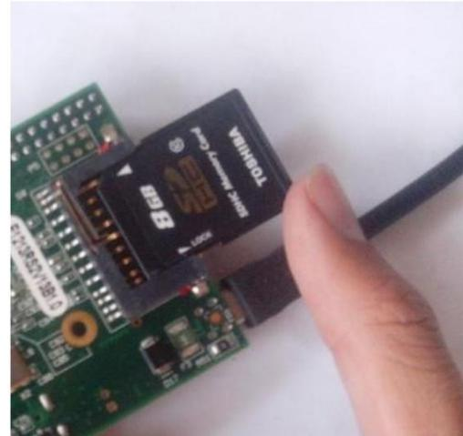
Gambar 5 Memasang Memory Card pada Raspberry Pi
