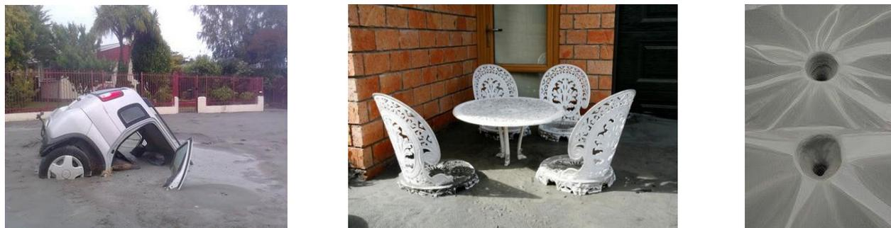
**Figura 5:** Affondamento di un'automobile e di sedie per perdita di capacità portante e vulcanelli di sabbia prodotti dalla liquefazione del terreno
