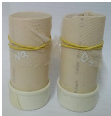
Fig.2: Amostradores passivos construídos para o estudo
