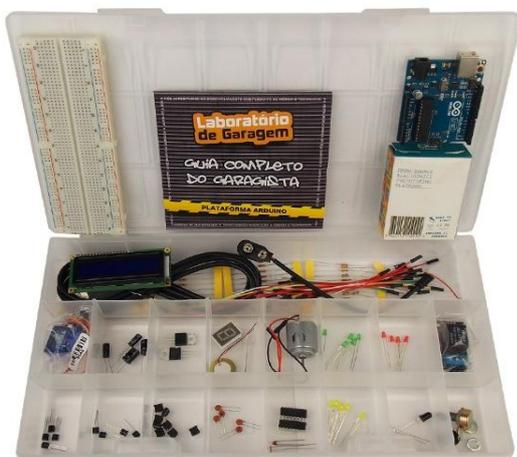
Fig.10 Componentes de um kit Arduíno
