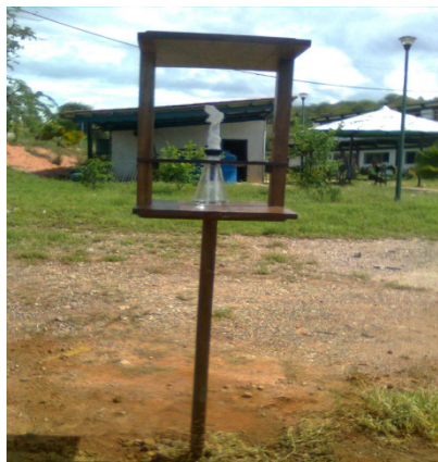
Figura 2. Dispositivo para la captación de cloruros en la atmósfera marina.
