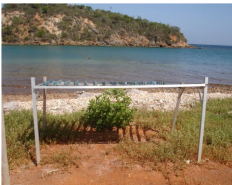
Figura 1. Bastidor instalado en la zona atmosférica con las probetas en experimentación.
