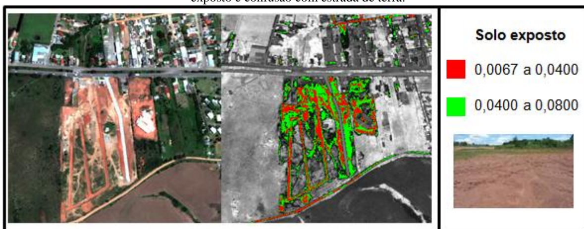
Figura 9 - Composição colorida GeoEye-1 (R3-G2-B1) a esquerda e imagem SAM (ângulo) à direita, com os valores angulares correspondentes para as áreas de solo exposto. A imagem mostra a clara discriminação das áreas de solo exposto e confusão com estrada de terra.
