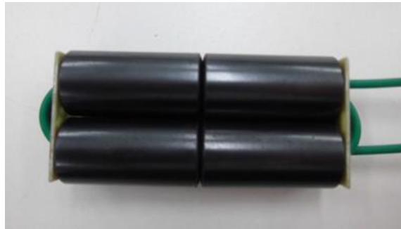
図 4-20 高効率型インバータの出力変成器の外観写真
