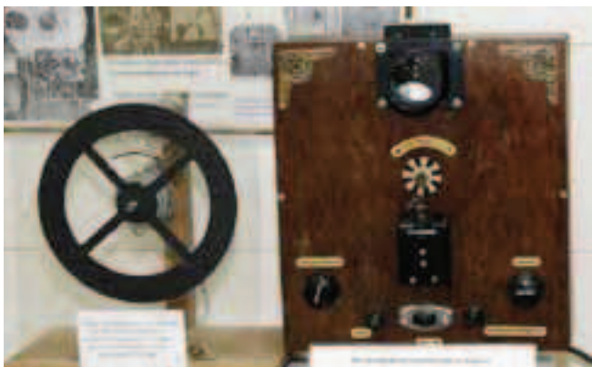
30-строчный механический телевизор (СССР, 1936 год)
