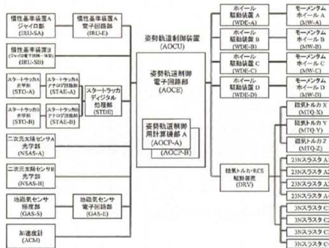
図 1.1 ASTRO-E の姿勢軌道制御系の機器構成 1)
