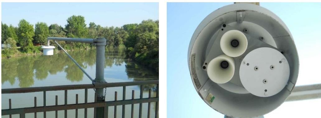
Figura 5: idrometro installato presso il ponte sul Po della SP122 Via Villastellone – Carignano (TO).
