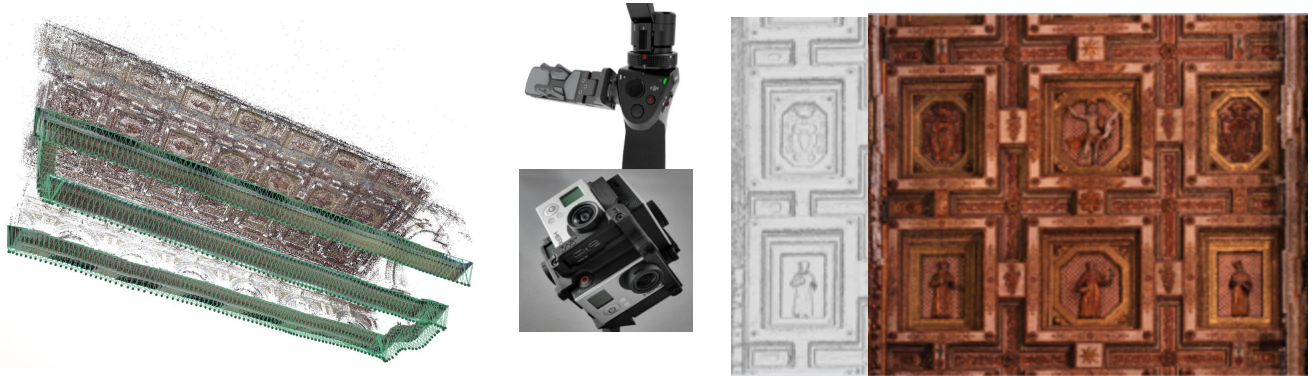
Figura 4 - Immagini orientate del soffitto a lacunari lignei settecentesco della Basilica di San Nicola acquisite con DJI Osmo e vista del modello 3D shaded e texturizzato (dx). Al centro (in alto) DJI OSMO e (in basso) Ring GOPRO (Kolor) utilizzato per l'acquisizione di immagini e video 360° per la realizzazione di prodotti 3D.
