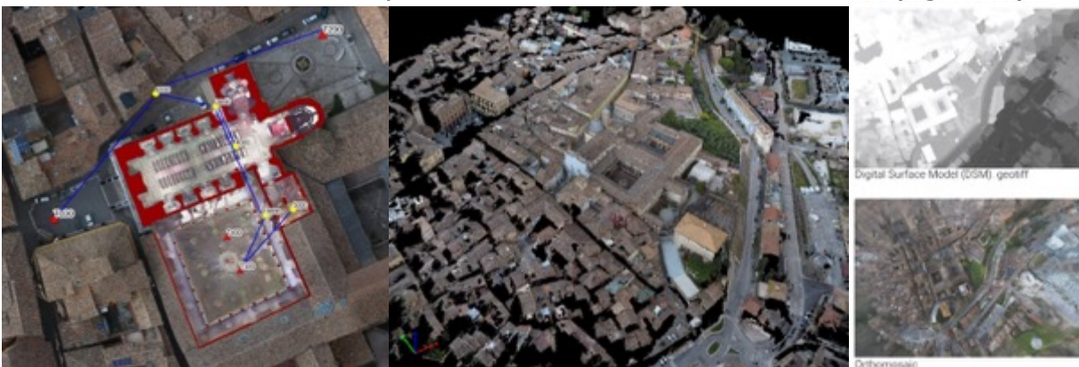
Figura 3 –Schema di una porzione della rete di inquadramento principale e secondaria integrate (sx). Nuvola di punti ricavata grazie al processo fotogrammetrico dai dati acquisiti sulla Basilica ed il suo intorno (centro). Alcuni elaborati prodotti: DSM densificato (dx alto), ortofoto (dx basso).
