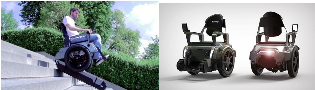
Figura 1.15 – Carrozzina con sistema di locomozione a ruote e cingoli SCALEVO [13]
