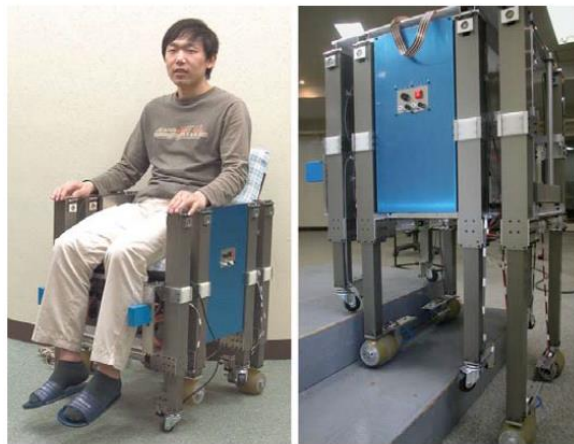
Figura 1.20 – Carrozzina montascale con sistema di locomozione a ruote e zampe, Yuan et al. [21], [22]
