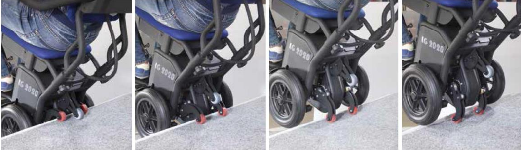
Figura 1.4 – Meccanismo di salita scalino del montascale LG 2020 (Antano)
