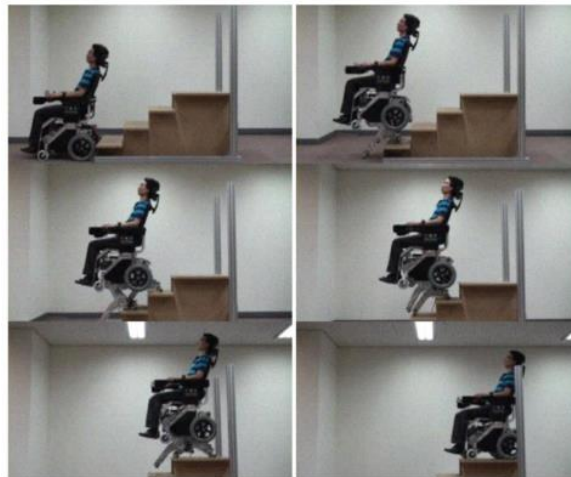
Figura 1.12 – Carrozzina con sistema di locomozione a zampe, Bang et al. [10]
