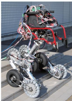
Figura 1.25 - Carrozzina montascale con sistema di locomozione a zampe rotanti, Sugahara et al. [27]
