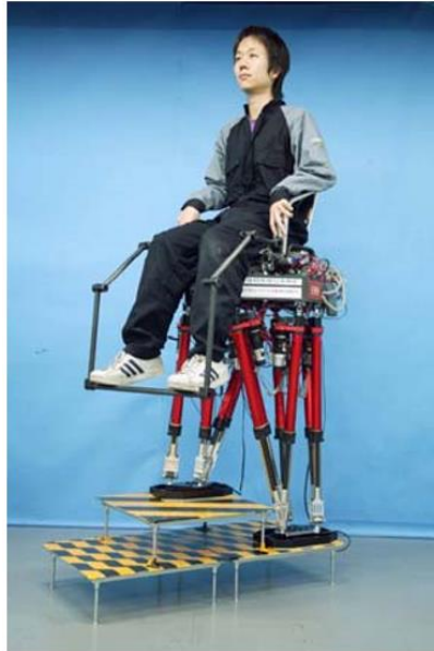
Figura 1.11 – Carrozzina con sistema di locomozione a zampe, Sugahara et al. [9]
