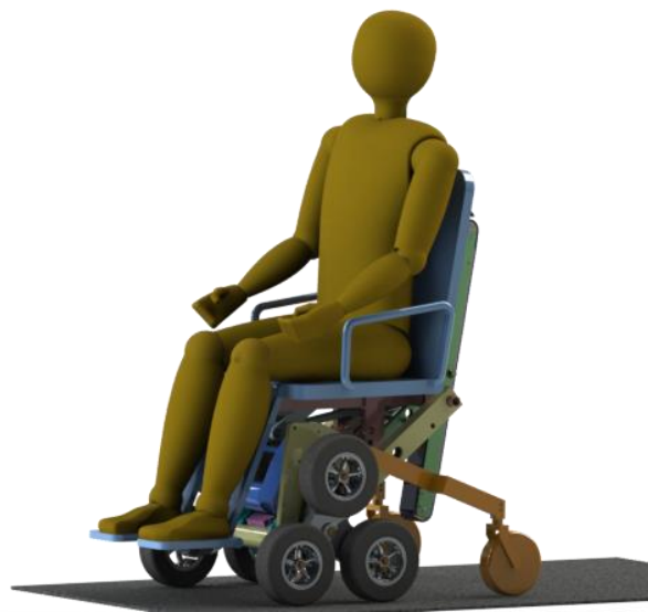
Figura 6.5 – Render del modello CAD del prototipo di carrozzina progettato
