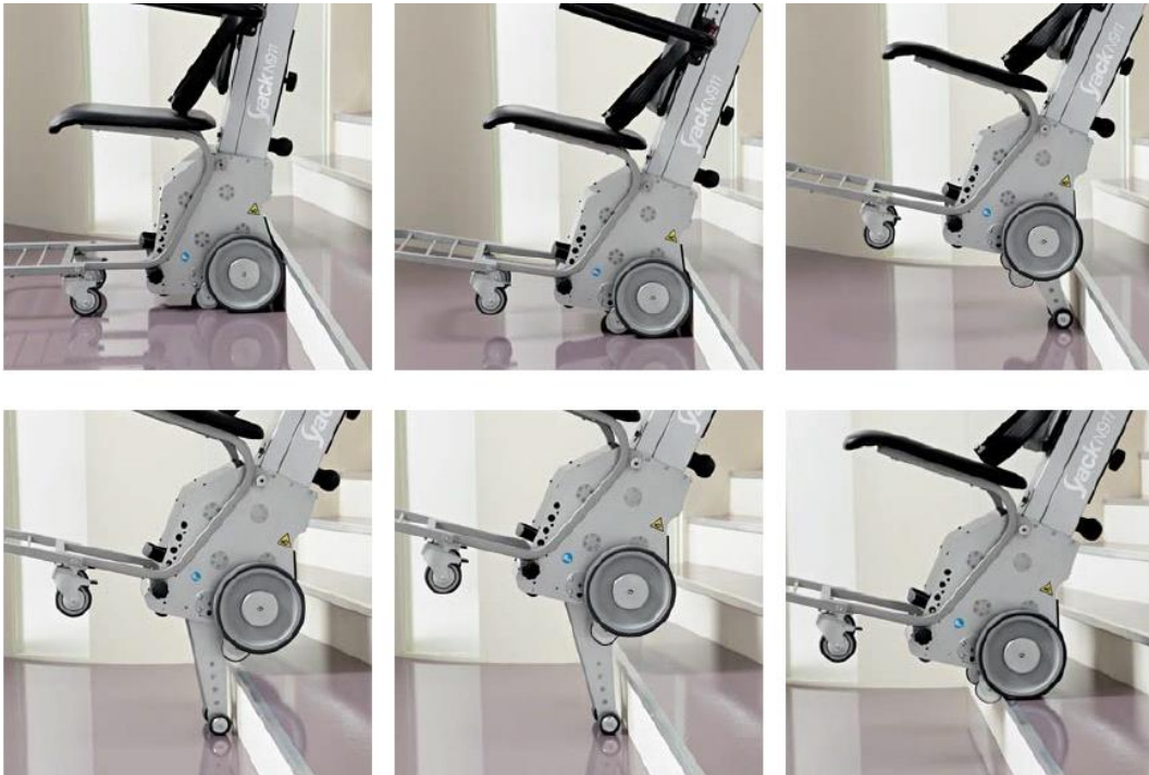
Figura 1.5 – Meccanismo di salita scalino del montascale Yack (KSP)
