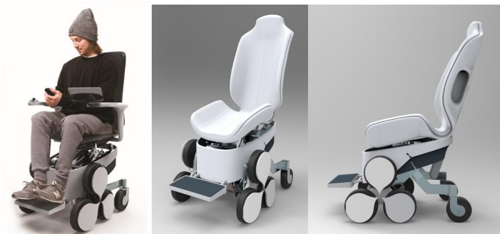
Figura I – Render della carrozzina montascale sviluppata e presentata in questo lavoro di tesi
