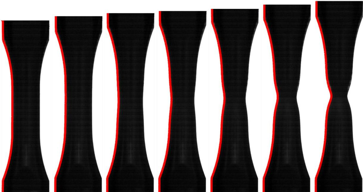
Figura 1: Esempio di elaborazione digitale dell'immagine per l'identificazione del profilo del provino in una prova di trazione: entrambi i lati del provino assialsimmetrico vengono rilevati e determinato il profilo medio dei due.
