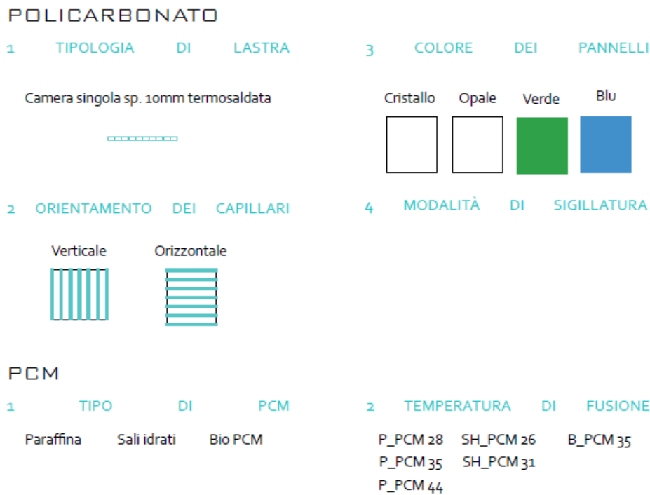
Figura 12 Schema variabili di progetto
