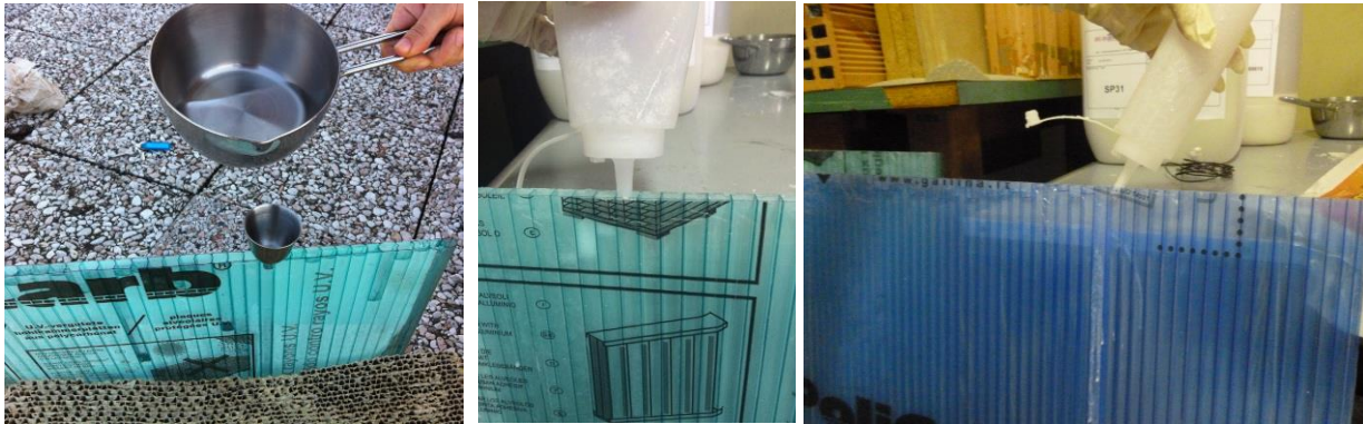
Figura 11 Riempimento del pannello in policarbonato alveolare con materiale a cambiamento di fase
