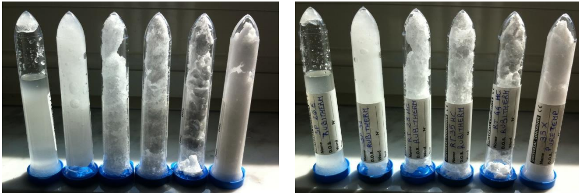
Figura 3 – Provini dei diversi PCM utilizzati nella sperimentazione.
