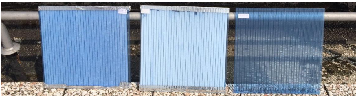
Figura 16 Configurazione 3 variante temperatura di fusione del PCM. Da sinistra Blu P_PCM 35, Blu P_PCM 44 e Blu vuoto.
