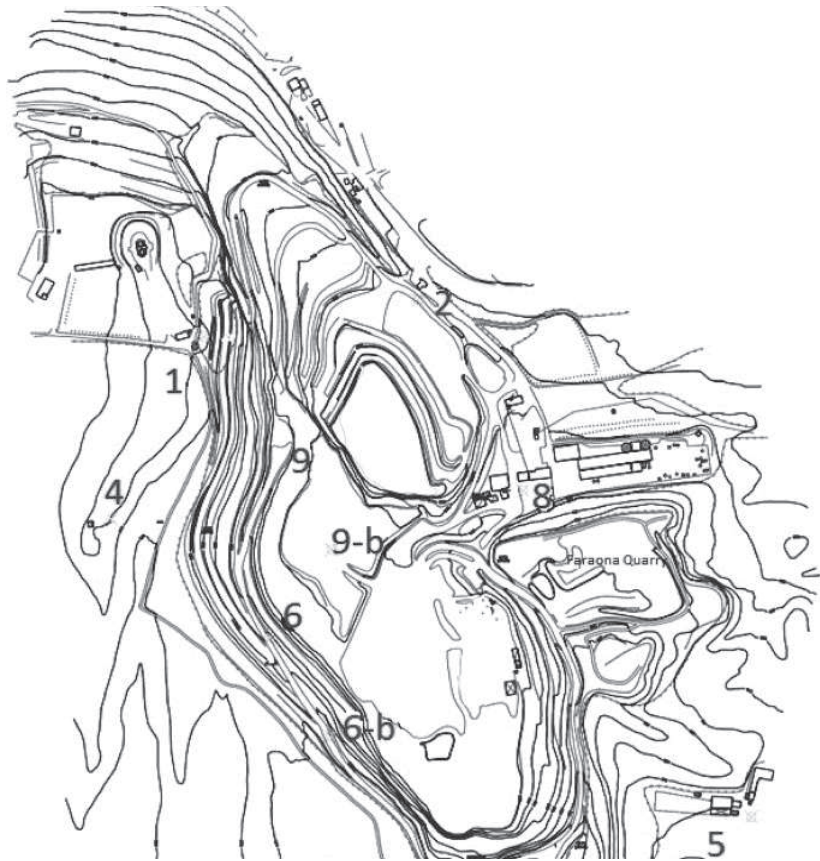
Fig. 1. Map showing the experimental positions adopted for vibration monitoring (point 3 and 7 are not represented, as they are located outside the area of quarry). Planimetria con l'indicazione dei punti sperimentali adottati per il monitoraggio vibrometrico (i punti 3 e 7 non sono rappresentati, essendo localizzati in area distante dall'area di cava).
