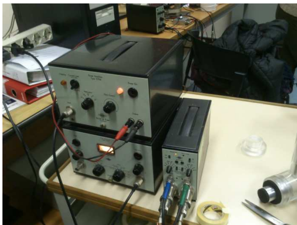
Figura 67 - Strumentazione utilizzata per la misura del coefficiente di assorbimento acustico (presso INRiM).
