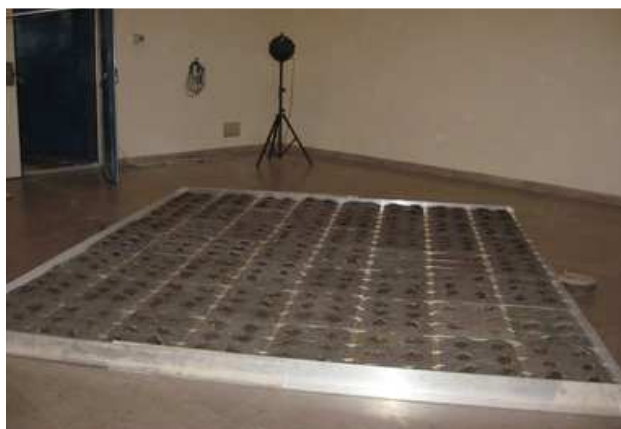
Figura 64 - Il campione GMS1 senza piante e substrato esterno in camera riverberante presso INRiM.
