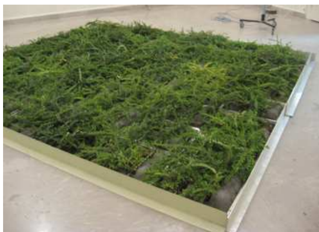
Figura 63 - Il campione GMS1 in camera riverberante presso INRiM.
