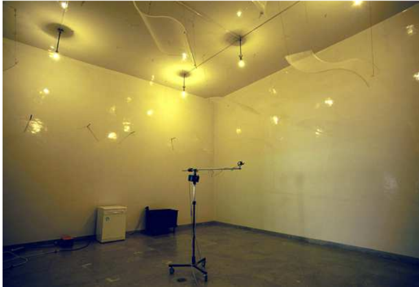
Figura 62 - La camera riverberante all'interno della quale sono state effettuate le misure del coefficiente di assorbimento acustico, presso l'INRiM di Torino. (Fonte: www.inrim.it )
