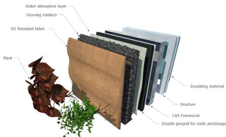
Figura 1 - Stratigrafia di un pannello vegetato.
