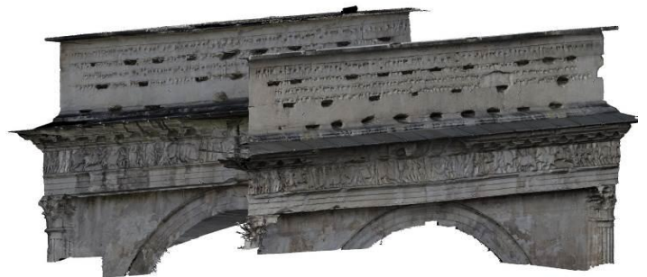
Figura 8 - A sinistra: mesh del fregio elaborata a partire dai dati fotogrammetrici; a destra: mesh del fregio texturizzata con ortofoto estratte dal modello fotogrammetrico.
