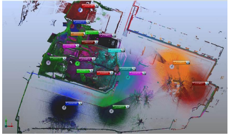
Figura 3 – A sinistra: acquisizione laser eseguita sopra l'acquedotto romano; a destra: visualizzazione della posizione delle diverse scansioni laser effettuate nell'area di scavo e del castello
