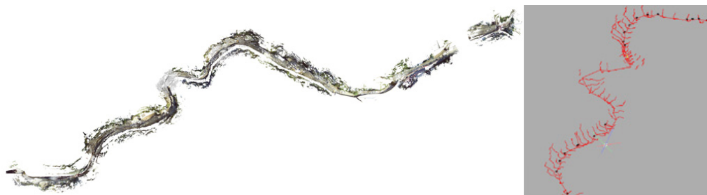
Figura 5. Vista d'insieme delle nuvole registrate dell'intero tratto di Vernazzola rilevato mediante metodo laser terrestre e stralcio di una vista 3D di sezioni trasversali speditive.
