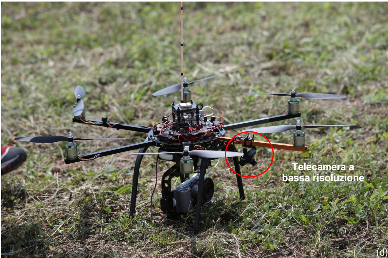
Figura 2: La camera digitale Sony NEX-5 (a), l'antenna del ricevitore GPS Ublox (b), l'elettronica di controllo (c) dal basso verso l'alto: BL, FC, NC, MK3Mag, MKGPS e l'Hexakopter di Mikrokopter (d).
