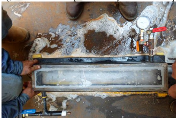
Figura N° 2.72: Inspección en fondos de tanques
