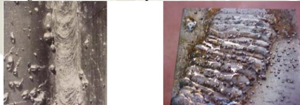
Figura N° 2.108: Salpicaduras de soldadura
