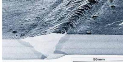
Figura N° 2.107: Desalineamiento en soldadura
