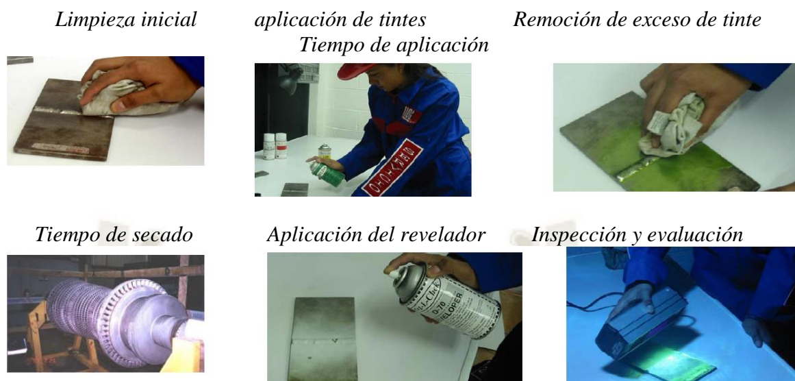
Figura N° 2.110: Procedimiento de tintes penetrantes
