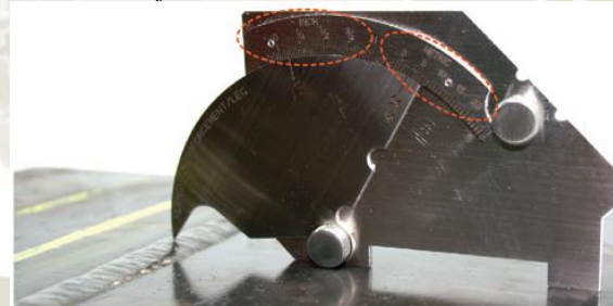
Figura N° 2.89: Verificación del cordón de soldadura
