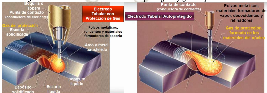
Figura N° 2.59: Procesos FCAW auto-protegido y gas de protección
