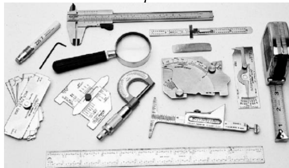
Figura N° 2.92: Herramientas de inspección visual de soldadura
