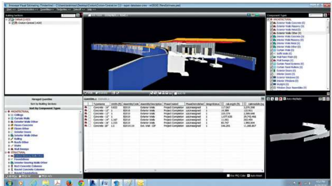
Figura 2. 29 : Pantalla de una estimación de costo usando el software Innovaya. Las placas resaltadas en azul están siendo revisadas por sus dimensiones y costo implicado.
