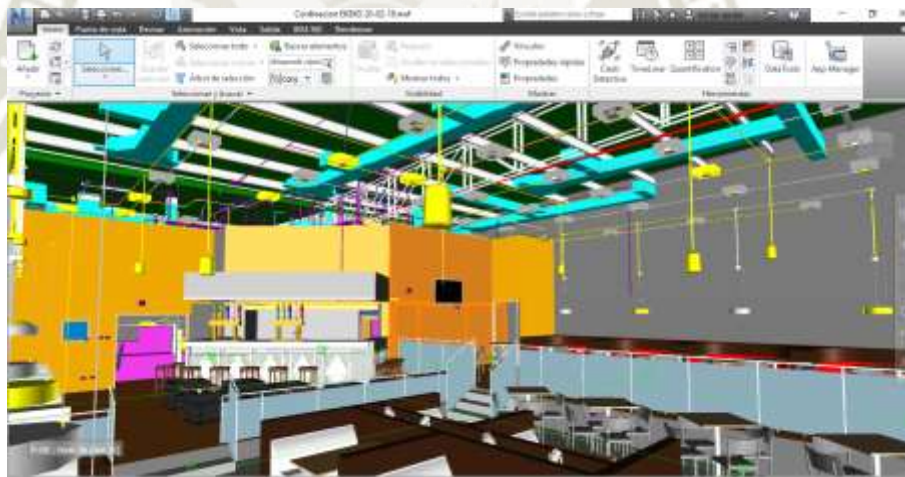
Figura 3. 46 : Vista digital de instalaciones en comedor.
