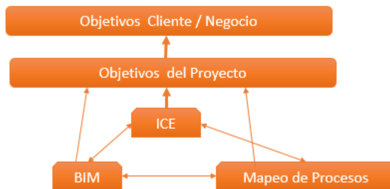
Figura 2. 21 : Esquema del enfoque VDC para gestionar productos, procesos, de manera integrada con ICE y lograr los objetivos.
