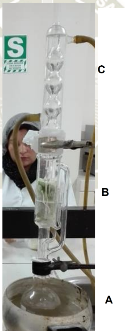
Fig. N° 5 Obtención de los extractos de las hojas de Grindelia glutinosa por el método de extracción por soxhlet.
