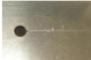
Fissure de fatigue (25.4mm)
