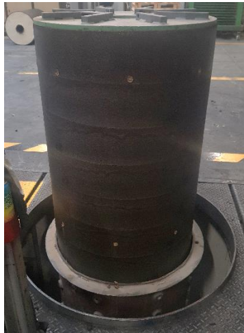
Figura 31 Cilindro Ply-Up desmoldado (com tampa)
