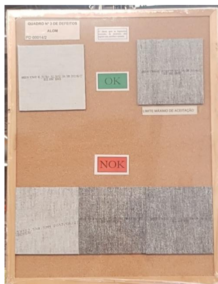
Figura 22 Norma de Inspeção para Impressão
