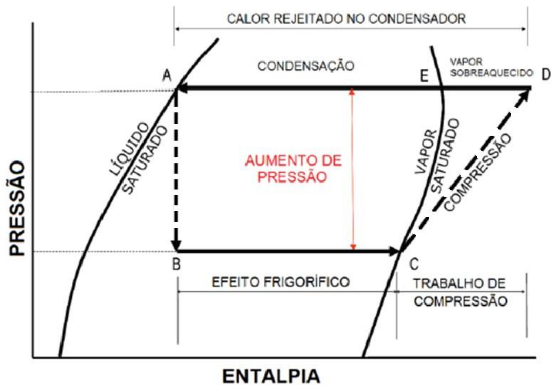
Figura 2.17 - Ciclo de compressão de vapor no diagrama p-h (Adaptado de: [29]).
