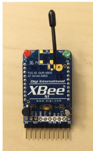
Fig. 3.2. XBee Series 1 module
