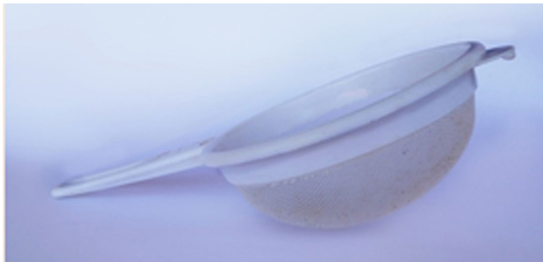
Figura 2. Peneira utilizada para coletar folhas e sedimento fino do fundo do riacho onde se encontravam os macroinvertebrados aquáticos.
