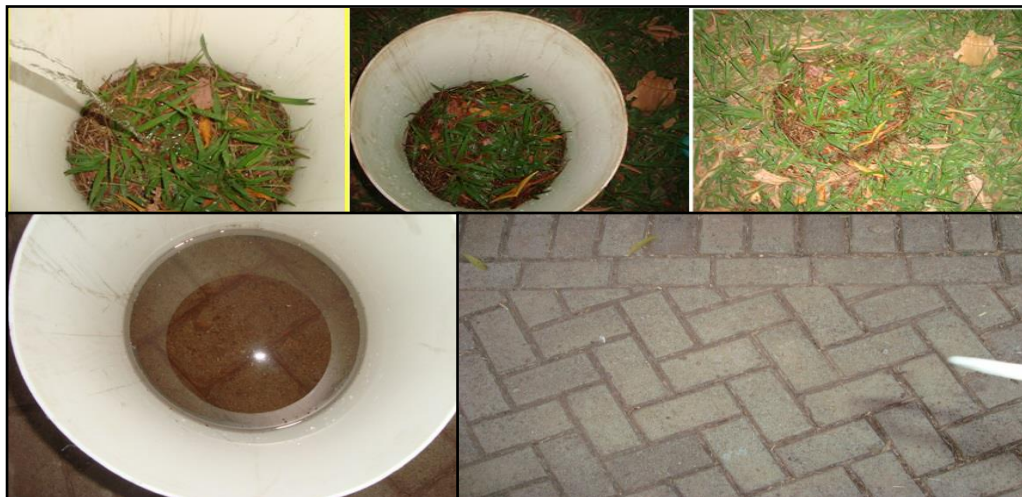
Imagem 2 - Locais de estudo para ensaios de infiltração realizados na grama e no pavimento intertravado
