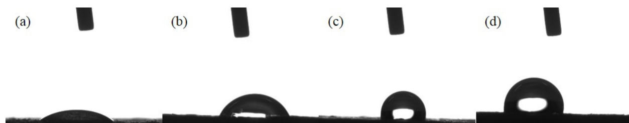
FIGURA 4: Gotas obtidas para cada tratamento; (a) sem temperatura; (b) 160°C; (c) 180°C; (d) 200°C.
