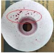
Gambar 9. Hasil pengujian menggunakan penetrant test dengan temperatur cetakan 175°C pada uji spesimen 1
