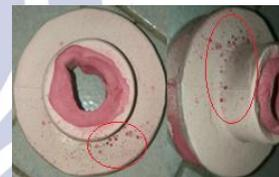
Gambar 12. Hasil pengujian menggunakan penetrant test dengan temperatur cetakan 25°C pada uji spesimen 2
