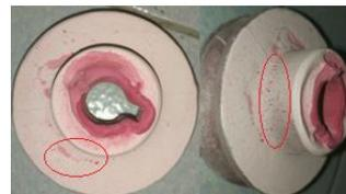
Gambar 14. Hasil pengujian menggunakan penetrant test dengan temperatur cetakan 125°C pada uji spesimen 2
