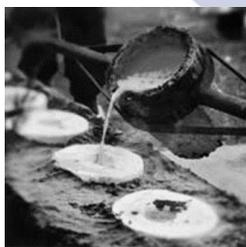
Gambar 3. Ladel Pengecoran
