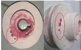
Gambar 16. Hasil pengujian menggunakan penetrant test dengan temperatur cetakan 225°C pada uji spesimen 2
