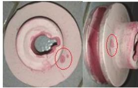
Gambar 15. Hasil pengujian menggunakan penetrant test dengan temperatur cetakan 175°C pada uji spesimen 2
