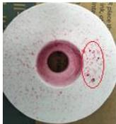
Gambar 10. Hasil pengujian menggunakan penetrant test dengan temperatur cetakan 225°C pada uji spesimen 1
