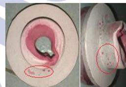
Gambar 13. Hasil pengujian menggunakan penetrant test dengan temperatur cetakan 75°C pada uji spesimen 2
