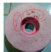
Gambar 8. Hasil pengujian menggunakan penetrant test dengan temperatur cetakan 125°C pada uji spesimen 1
