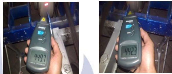
Gambar 2. Uji Kecepatan Rpm Maksimal Tanpa Beban Pada Motor Penggerak
