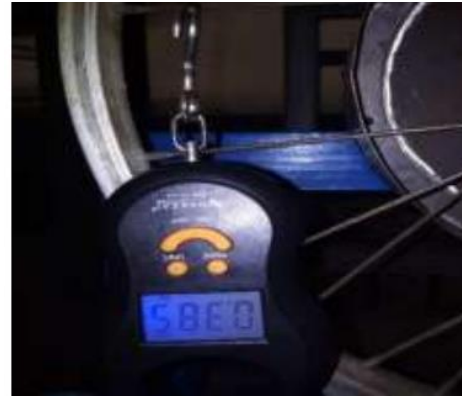
Gambar 8. Pengujian torsi berdasarkan putaran spring
