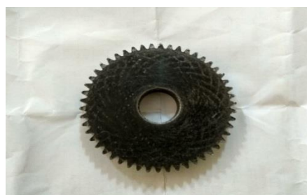
Gambar 5. Hasil pabrikasi carrier gear
