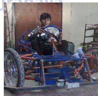
Gambar 6. Pengujian lengan dan *long tie rod* pada sistem kemudi mobil listrik (Sumber: Dokumentasi)
