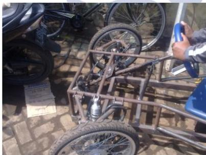
Gambar 4. Pengujian batang kemudi dan *steer* pada sistem kemudi mobil listrik (Sumber: Dokumentasi)
