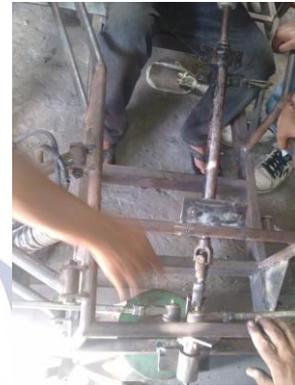
Gambar 5. Pengujian plat penghubung antara batang kemudi dengan lengan *tie rod* pada sistem kemudi mobil listrik Unesa (Sumber: Dokumentasi)
