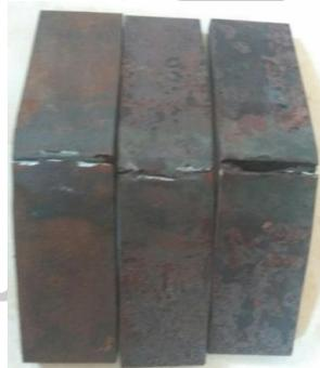
Gambar 3. Hasil Uji Bending Spesimen 200°C
