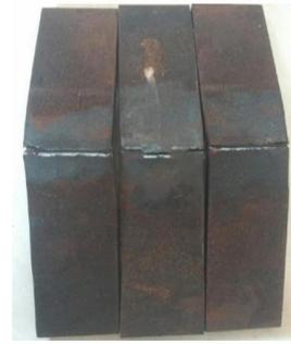
Gambar 4. Hasil Uji Bending Spesimen 400°C
