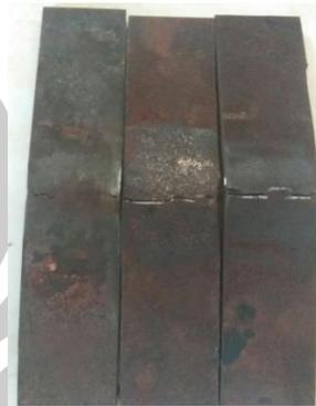
Gambar 5. Hasil Uji Bending Spesimen 600°C
