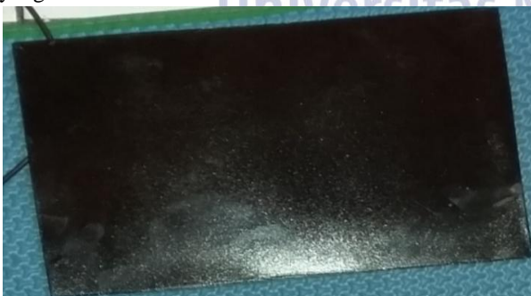
Gambar 10. Permukaan Cat Pada Plat Terlihat Kasar
