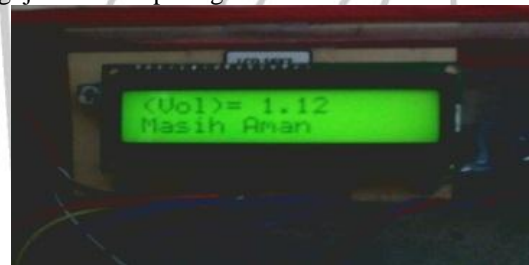
Gambar 9. Pengujian Sensor Gas Pada Kondisi Aman
