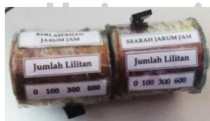
Gambar 2. Alat percobaan hukum Lenz yang telah direvisi (Dokumen Pribadi)
