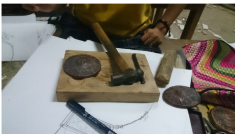
Gambar 3.2 Hasil logam setelah dicembungkan. (Dokumen Wening 2015)
