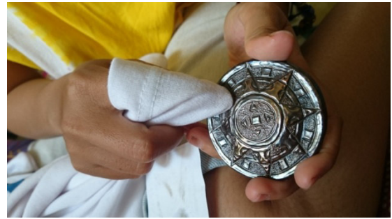
Gambar 3.3 Menggosok dengan autosol (Dokumentasi Wening 2015)
