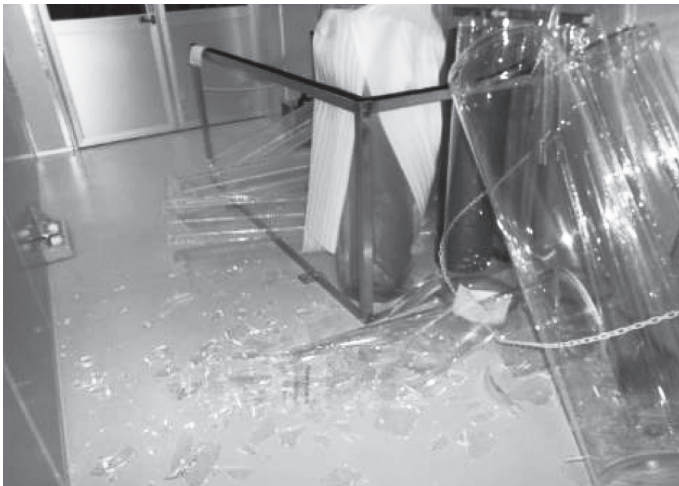
写真2 石英ガラス治具の損傷
