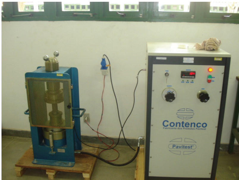
Figura 4 - Ensaio de Resistência à compressão
