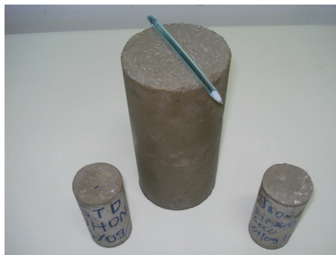
Figura 2 - Corpos de prova com fibra de coco
