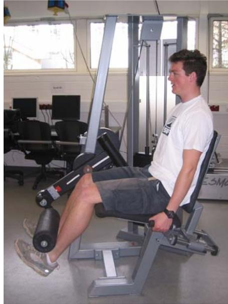
Abbildung 9: Isometrische Maximalkraftmessung bei einem Kniewinkel von 120°.
