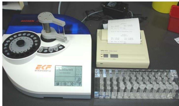
Abbildung 11: Laktatanalysegerät „BIOSEN C\_line“<sup>®</sup> der Firma EKF-diagnostic GmbH mit portabilem Drucker und Laktatprobenhalter.
