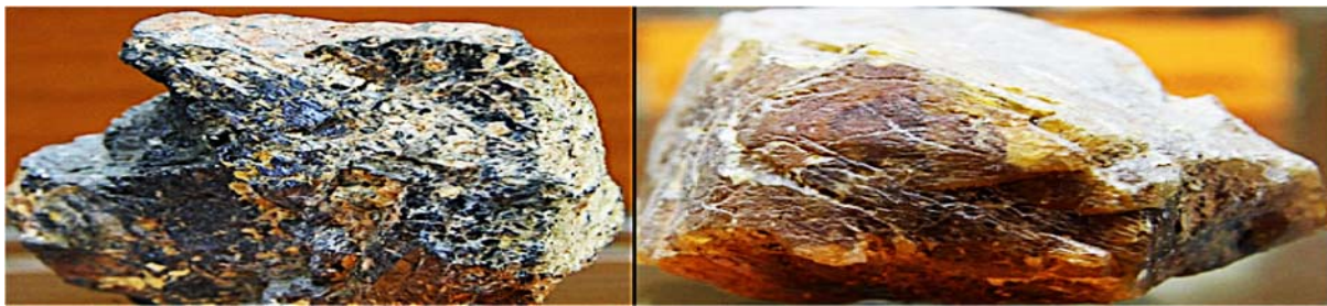
Figura 125. Izquierda: Wolframita. Ledesma, Salamanca, España. Derecha: Scheelita. Barruecopardo, Salamanca, España. Colección de minerales del Departamento de Edafología de la UCM.
